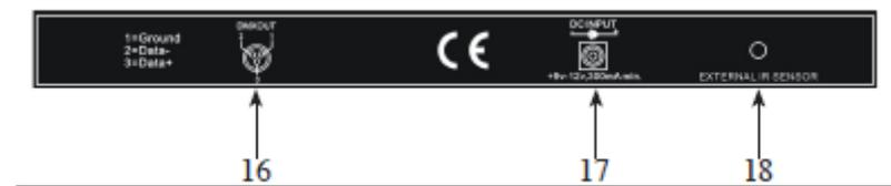
16. SALIDA DMX: se usa para enviar señal DMX a dispositivos LED compatibles.
